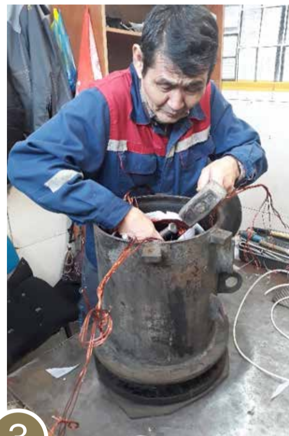
Электрослесарь по обслуживанию и ремонту оборудования производит перемотку двигателя.
